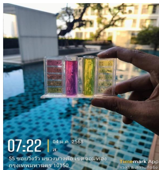
ภาพที่ 4.5-1 การตรวจวัด pH และ Free Chlorine สระว่ายน้ำ
